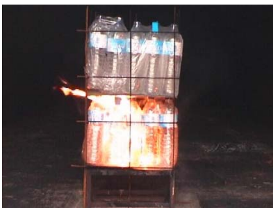
Photo 5 : Départ de feu dans l'essai 3 (t = 3 min)
